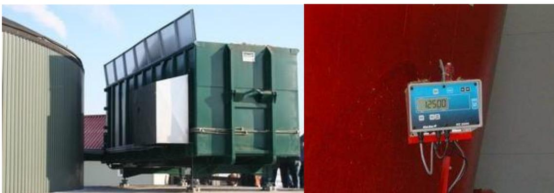
Abbildung 21: Vorlagebehälter mit Wiegeeinheit
