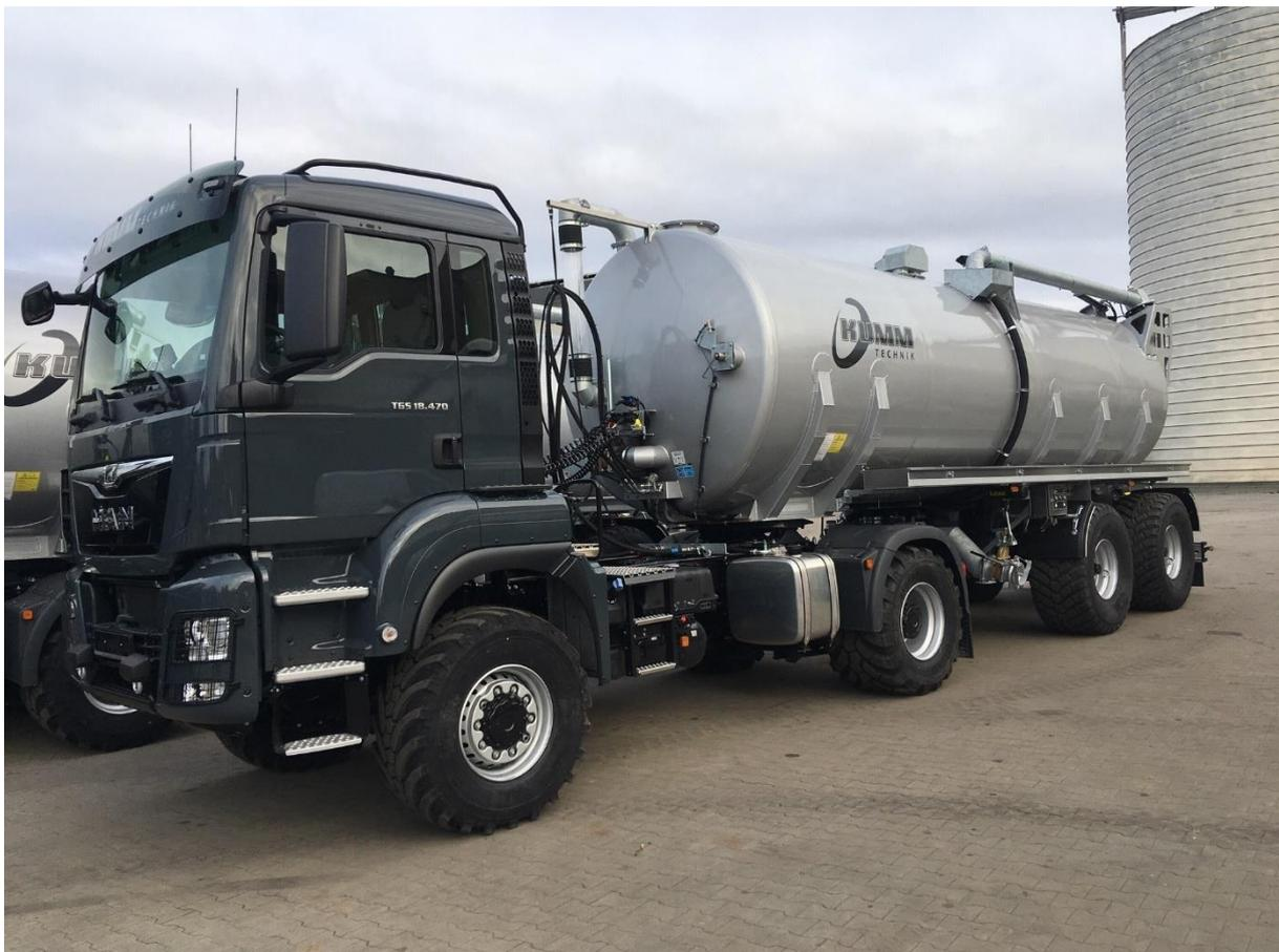
Abbildung 12: Güllefass mit LKW als Zugfahrzeug
