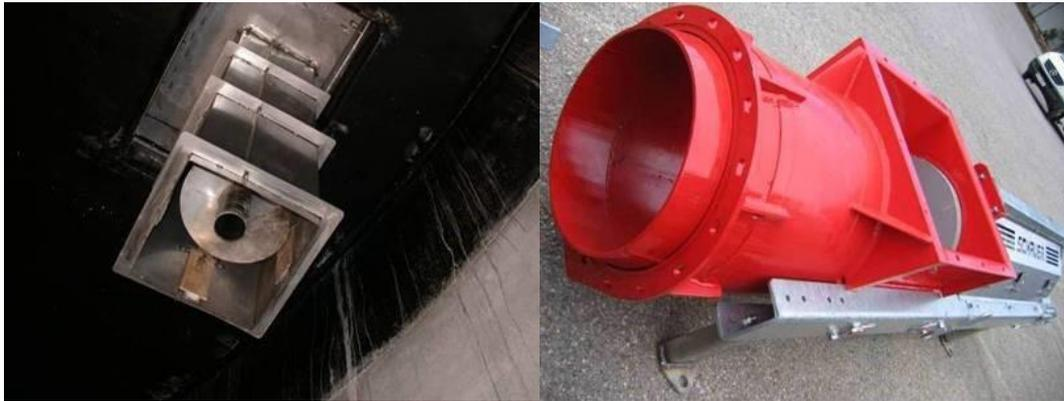
Abbildung 20: Eintragungsschacht für feste Gärsubstrate
