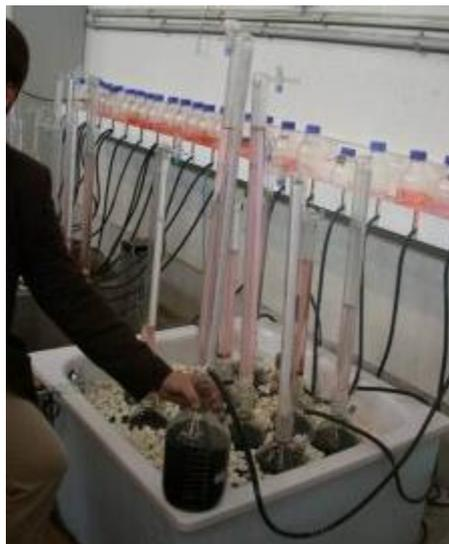
Abbildung 26: Batch-Versuch des Gärsubstrates
