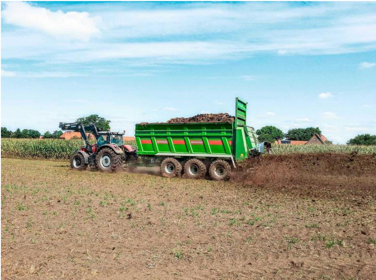
Abbildung 13: Ausbringung des festen Gärrestes mit Streufahrzeug
