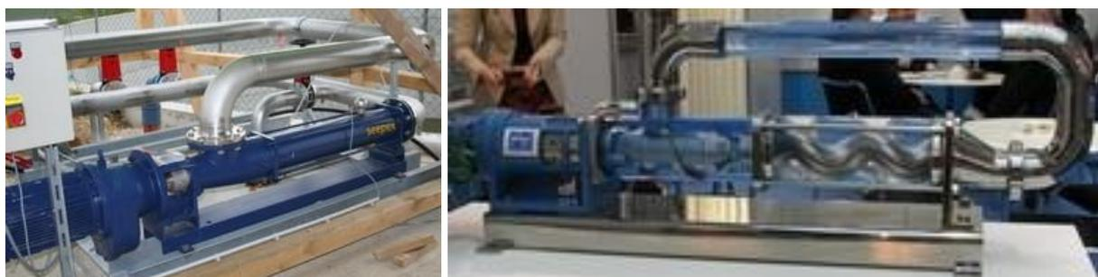
Abbildung 17: Exzentrerschneckenpumpe
